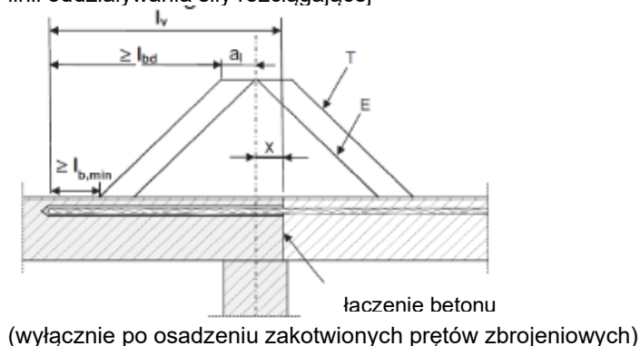
Rysunek A5: Kotwienie zbrojenia wzmacniającego, dla pokrycia linii oddziaływania siły rozciągającej
