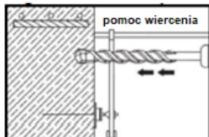
Rysunek B2: Przykład wiercenia z prowadnicą
